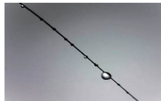
Goutte de glycérol sur une fibre métallique en acier inoxydable, de 3 μm de diamètre.
